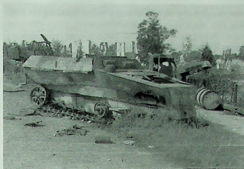
Een van de wrakken van de SPWs (nummer XVII op het kaartje op blz. 12). Het is een Sd.Kfz.250/1 neu, en het is duidelijk door het uitschot aan de rechtervoorzijde dat het aan de linkerzijde is getroffen: de granaat ging er dwars door heen.
